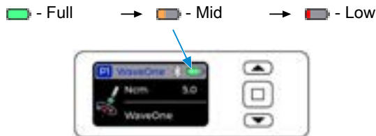
Fig. 6 : Battery status indicator
